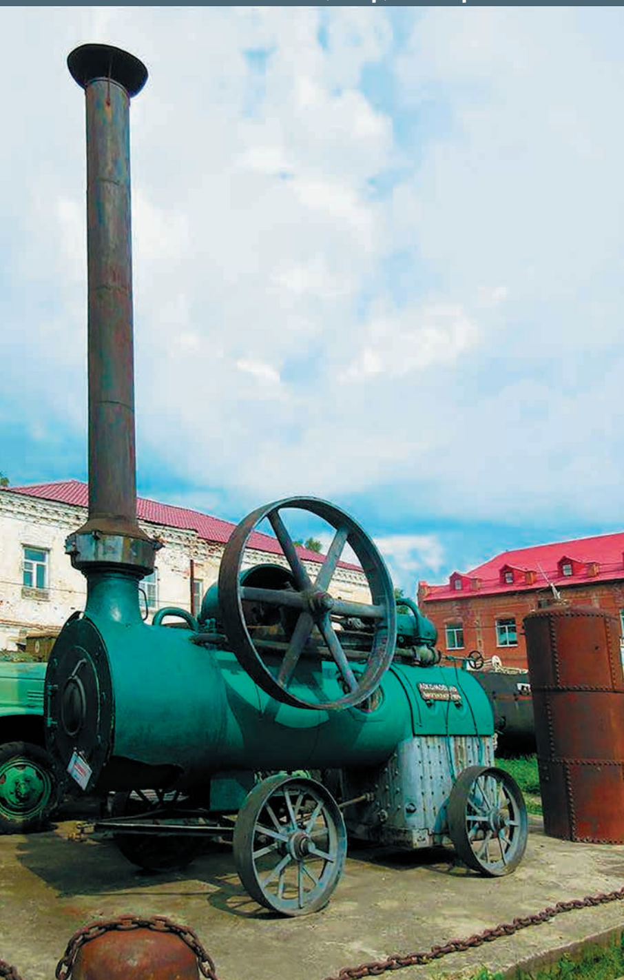
Так выглядел локомотив для получения электроэнергии jurideryshev.livejournal.com, автор неизвестен
