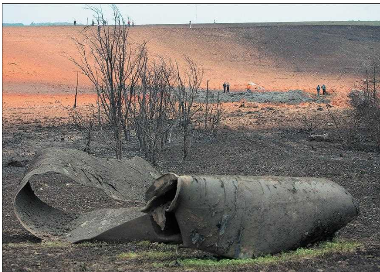
Так давление корёжит трубы диаметром почти в рост человека
